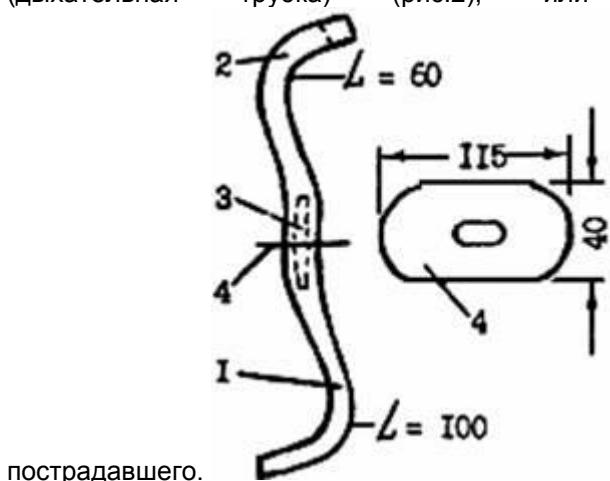
1, 2 - гибкая пластмассовая трубка диаметром 8-12 мм, длиной 60 и 100 мм;
